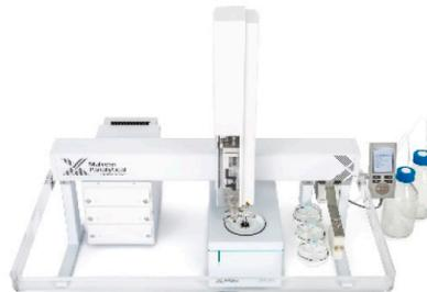
溶液中の分子構造の熱変化を測定、熱安定性を評価します
