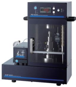
任意の圧力下で粉体の体積抵抗率を自動測定
